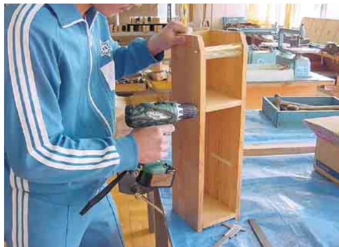
物入れの棚を固定するのに木ねじを打っている様子
